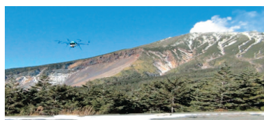
図表4-1 火山ガス観測のために離陸する火山観測ドローン 噴火直後の御嶽山において2014年11月21日撮影 (長野県王滝村・田の原天然公園)
